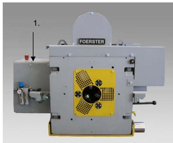
Bild 13 Rotierkopfelektronik mit Not-Aus-Schalter
