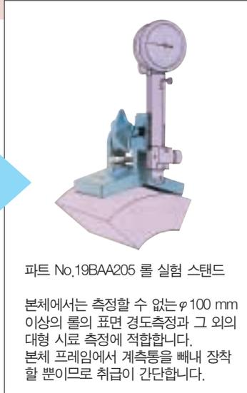
쇼어 경도시험기는 시험기나 그 시험 방법 등이 JIS 규격에 준거하여 간단하게 경도를 측정할 수 있는 시험기입니다. 이 쇼어 경도시험기는 압연 롤과 같이 치수가 크고 질량이 큰 재료 측정시 이동이 곤란할 경우, 최종 마무리면의 경도 측정에 최적인 시험기입니다. 컴팩트한 몸체로 이동이 편리하고 계측 통을 제거하면 제품 위에서도 직접 경도를 측정할 수 있습니다.
