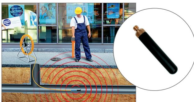
Der Molchsender MLS 55-3 ist ein batteriebetriebener Minisender und hat eine Reichweite von 5 m. Zur Ortung von Leerrohren oder Verstopfungen wird er auf ein Schubkabel aufgeschraubt. Alle gängigen Adapter sind im Set enthalten. Optional ist eine extra Schutzhülle erhältlich.
